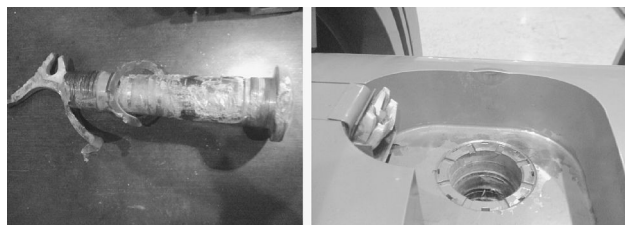
图 6 转子本体上导电螺钉飞逸
