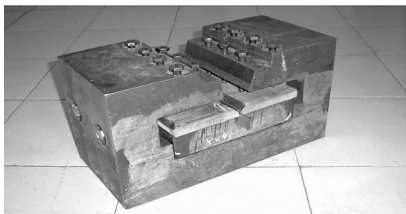
图 5 夹具装载试件后的照片
