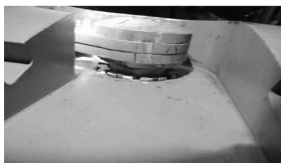
图 8 转子导电螺钉明显的移位
