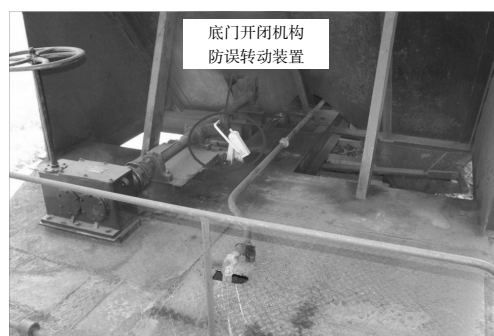
图 8 改造后的 K 18DF 型车辆现车图
