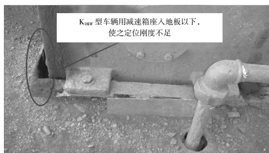
图 6 K 18DF 型车辆用减速箱安装图
