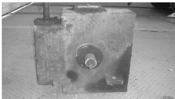
图 4 K 18DF 型车辆用减速箱
