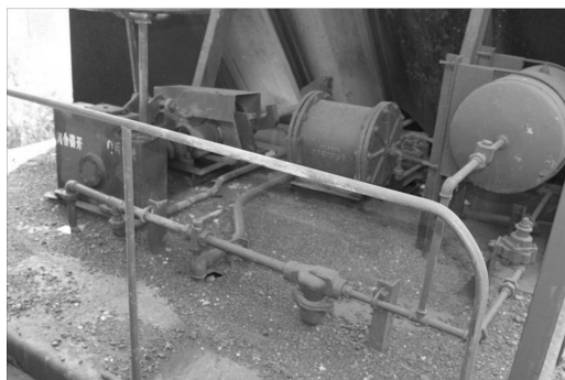
图 3 K 18DF 型车辆底开门减速箱及风动卸车装置
