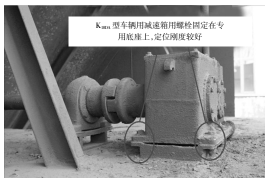
图 7 K 18DA 型车辆用减速箱安装图
