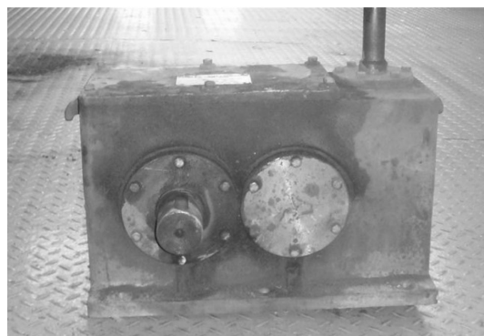
图 5 K 18DA 型车辆用减速箱
