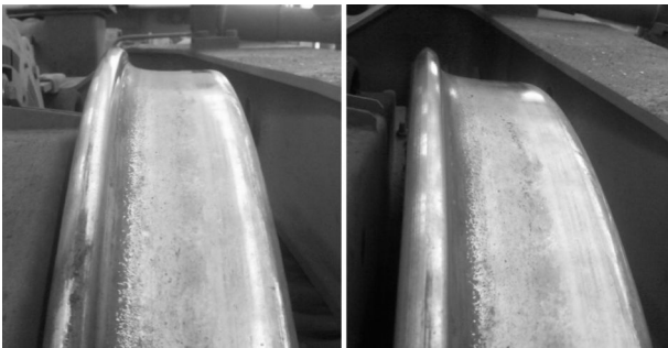
图1 磨耗后机车车轮型面
