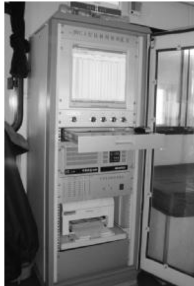
图 11 接触网检修作业车车载接触网智能动态检测系统车内主机
