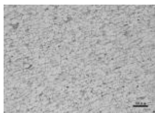
图 7 靠近裂口处管段金相组织分析, 铁素体 + 碳化物 (球化 4.5 级)
